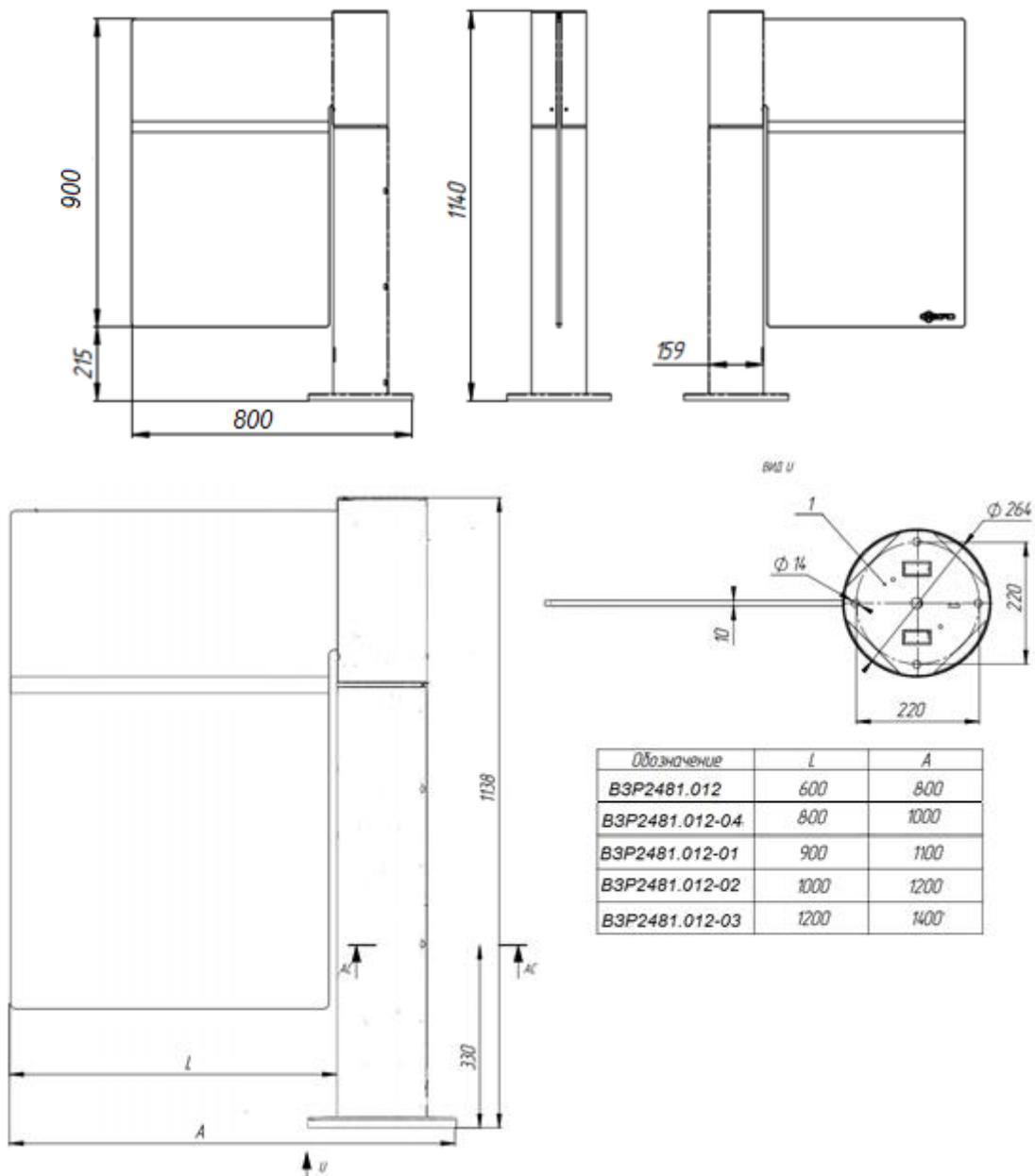
Рисунок 1 – Габаритные размеры изделия для калитки со стеклом.
