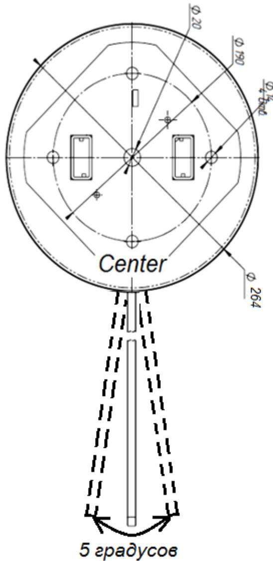
Рисунок 3 – Возможный свободный ход калитки в режиме «STOP»
