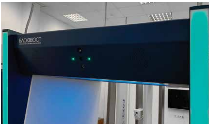
Встроенная тепловизионная камера
