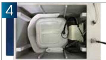
Соединительные элементы подачи дезраствора и подключение электропитания
